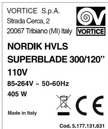
Fig. 1 - esempio targa dati SUPER BLADE 300/120'' 110V
